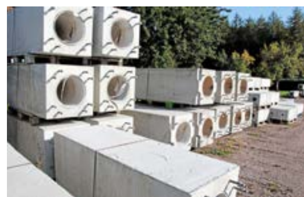
Fundament till stolpar uppradade på gårdsplanen i väntan på leverans.
