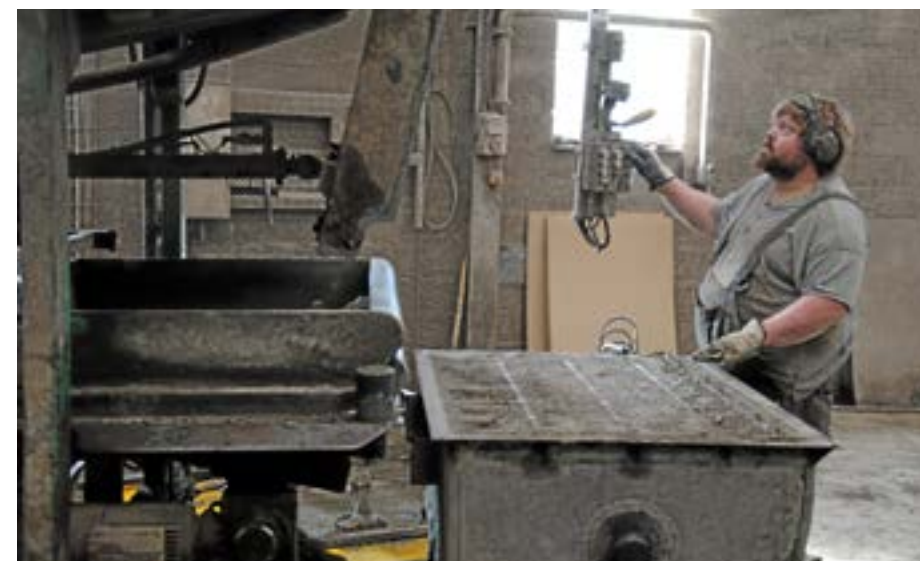
Daniel Nygren gjuter betongplintar. När formarna är fyllda slås luftbubblorna bort så att cementen sätter sig.
